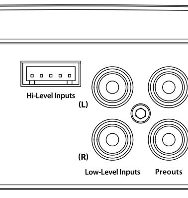
Der Verstärker kann sowohl mit einem Mono- als auch einem Stereo-Signal betrieben werden. Die Eingangsschaltung summiert für den internen Verstärker automatisch das Stereo-Signal zu einem Mono-Signal. Der Verstärker funktioniert auch mit nur einer Cinch-Anschlussbuchse, aber dies erfordert eine höhere Pegeleinstellung der Eingangsempfindlichkeit um den Verlust des Mono-Signals auszugleichen.
