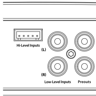
Puede pasar una señal estéreo o mono a las entradas del amplificador. La sección de entrada del amplificador suma automáticamente las señales estéreo a mono para la sección de amplificación interna.
