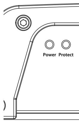
El panel de control del amplificador tiene dos luces indicadoras de estado. Estas son las siguientes:
