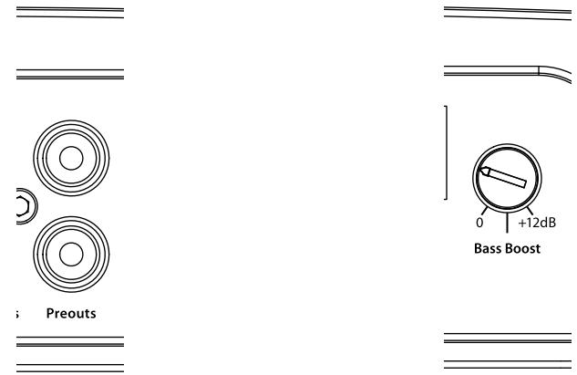
Der Vorverstärker-Ausgang liefert das gleiche Signal wie jenes, das in die low-level Eingänge gespeist wird. (Wenn die Eingangssignale im Vollbereich (full-range) sind, sind auch die Vorverstärker-Ausgänge im Vollbereich.) Dieses Signal wird nicht beeinflusst vom „**Bass Boost**“ (Bassverstärker) oder der Filterwahl.
