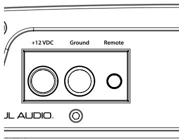
L'amplificateur s'allume lorsqu'une tension de +12 V est présente à l'entrée « **Remote** » (à distance) et s'éteint lorsque la tension de + de 12 V est coupée. Si une unité source ne dispose pas d'une sortie d'allumage à distance dédiée, le câble d'allumage de l'amplificateur peut être connecté sur +12 V par l'intermédiaire d'un commutateur qui dérive l'alimentation d'un circuit d'allumage à interrupteur.
