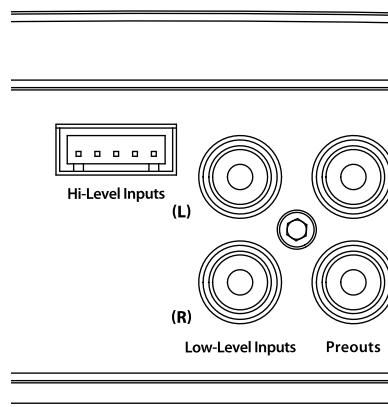
Vous pouvez envoyer un signal stéréo ou mono dans les entrées de l'amplificateur. La section d'entrée de l'amplificateur additionne automatiquement les signaux stéréo pour la section d'amplificateur interne.
