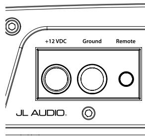
Der „+12 VDC“ (positiv) und „Masse“ (GROUND) Anschluss sind dafür ausgelegt, Kabel bis zu 25mm<sup>2</sup> aufzunehmen.
