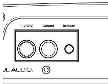
Der „Remote“-Anschluss ist für die Aufnahme eines Kabels mit einem Querschnitt von  $1,5\text{mm}^2$  ausgelegt. Am Ende des Kabels sollten Sie etwa 12mm der Kabelisolation abziehen. Dann führen Sie das abgesetzte Ende soweit in den „Remote“-Anschluss, bis kein blankes Metall am Kabel mehr zu sehen ist. Schrauben Sie die Steckverbindung mit Hilfe des 2,5mm Innensechskantwinkelschraubenschlüssels vorsichtig fest.
