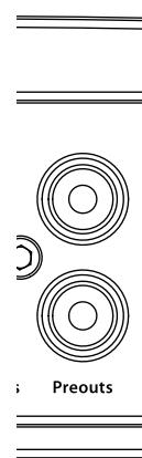
Estas salidas de bajo nivel entregan la misma señal que se envía a las entradas de bajo nivel. (Si las señales de entrada son de rango completo, las salidas de bajo nivel serán de rango completo.) Esta señal no se ve afectada por el refuerzo de bajos o el procesamiento de filtro seleccionados para el amplificador.
