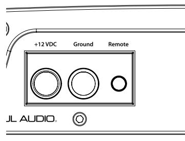
El amplificador se encenderá cuando haya +12 V en la entrada "Remote" (Remoto) y se apagará cuando se desconecte la alimentación de +12 V. Si la unidad fuente no posee una salida dedicada de encendido remoto, el cable de encendido del amplificador puede conectarse a la conexión de +12 V mediante un interruptor que derive la alimentación de un circuito comutado por el encendido.
